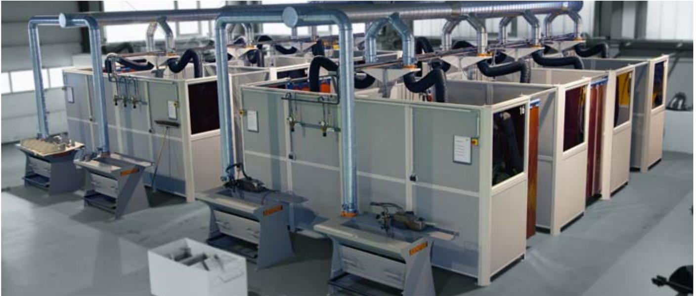
Das KEMPER Schallschutz- und Trennwandsystem ist aus verschiedenen Systemelementen beliebig kombinierbar.
