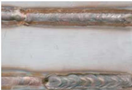
Korrosion an einer nicht behandelten Edelstahl-Schweißnaht
