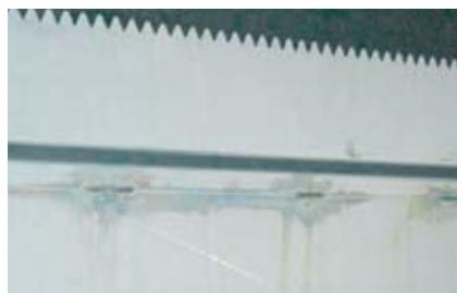
Doppelungen im Schweißnahtbereich, Schweißnähte nicht dicht geschweißt, Beizchemie in Doppelungen – unsauber gespült
