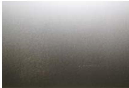
Sogenanntes Leopardenmuster durch zu große Sprühdüsen-Bohrung
