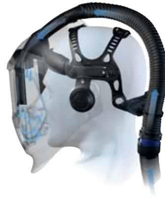
**Airflow:** Der mittlere Kanal hält den Schweißfilter beschlagfrei, die beiden Seitenkanäle sorgen für sanfte Luftzufuhr in die Mund- und Nasenregion.
