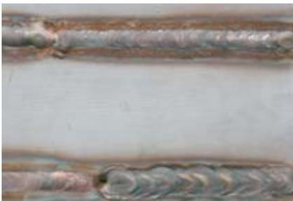
Korrosion an einer nicht behandelten Edelstahl Schweißnaht
