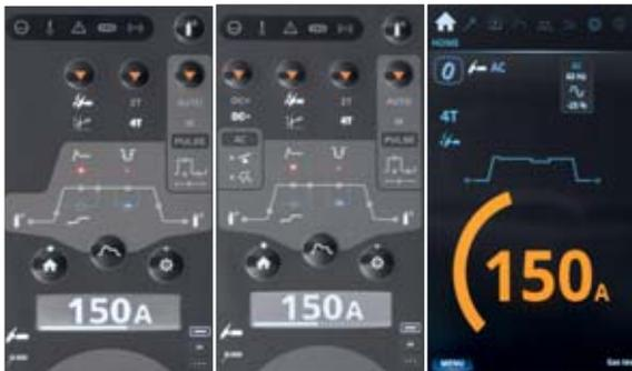
V. l. n. r.: Bedienpanels MTP23X, MTP33X und MTP35X (Standardausrüstung bei MasterTig 535)
