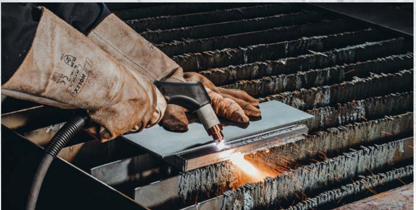
Zum Plasmaschneiden sind eine Plasmaströmquelle, ein Plasma-brenner und eine Gasversorgung erforderlich. Die gängigsten Plasmaströmquellen haben eine Stromstärke von 30 bis 800 A, sie haben einen Brenner, der an die Gasversorgung angeschlossen ist. Die Systeme sind in zwei Hauptkategorien unterteilt: Ein- und Mehrgas.
