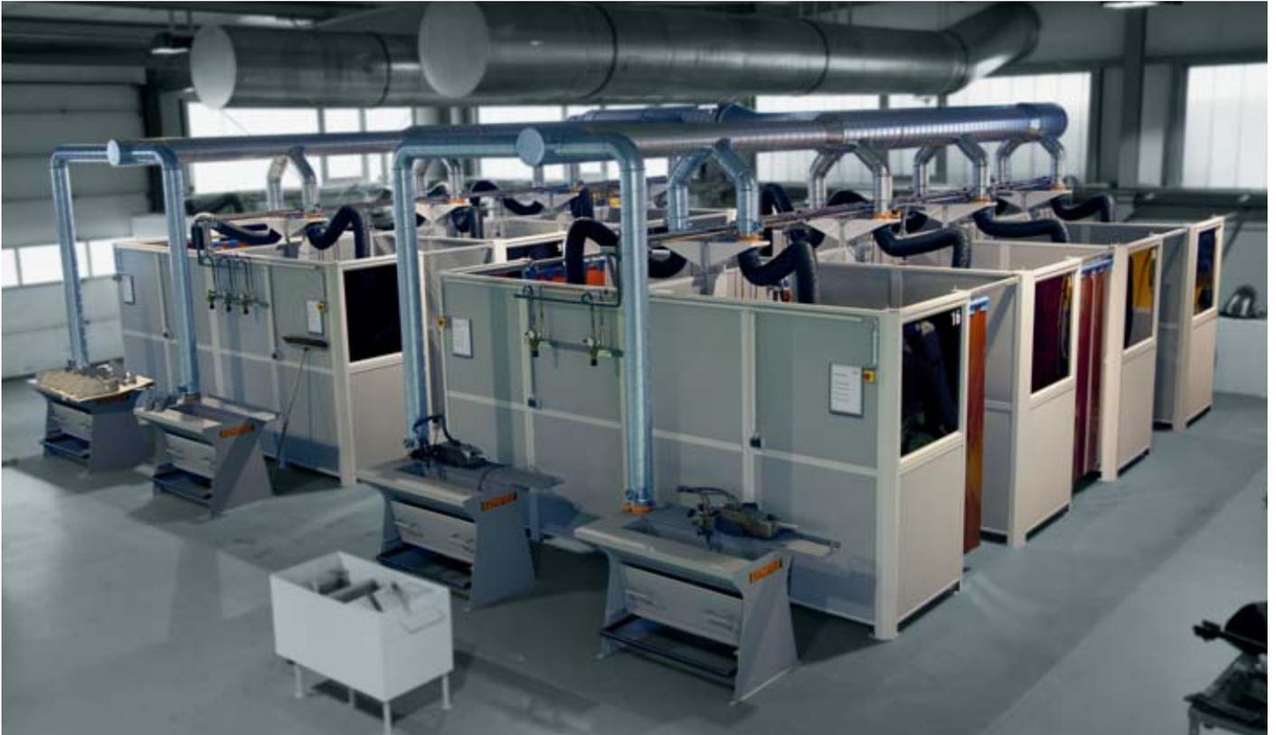
Das KEMPER Schallschutz- und Trennwandsystem ist aus verschiedenen Systemelementen beliebig kombinierbar. Stützen und Querstreben bestehen aus Profilstahl und sind mit UV Strahlen hemmender Pulverbeschichtung versehen.
